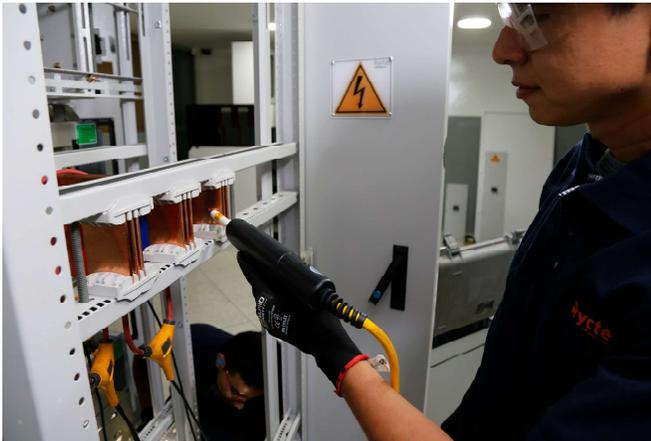
Las pruebas electricas, en términos generales, producen esfuerzos similares a las condiciones reales de operación de los equipos, como las pruebas de factor de disipación, pruebas de relación de transformación, reactancia de dispersión, resistencia a tierra y potencial aplicado a frecuencia nominal o a baja frecuencia.
