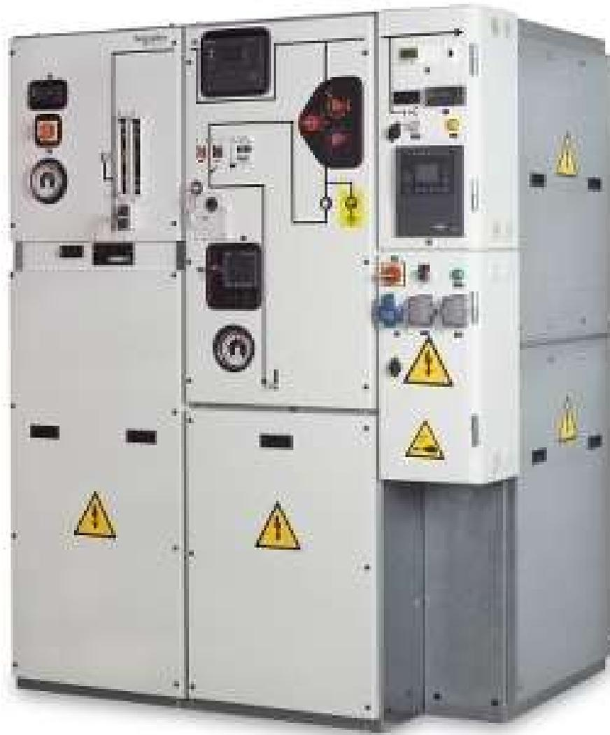
RYCTEL comercializa toda la gama de celdas compactas modulares para niveles de función 1 y 2. Adicionalmente, fabrica celdas compactas modulares para medida y remonte con aislamiento interior en aire. Construídas en lámina galvanizada calibre 14, aplicables para tensiones hasta 36kV.
